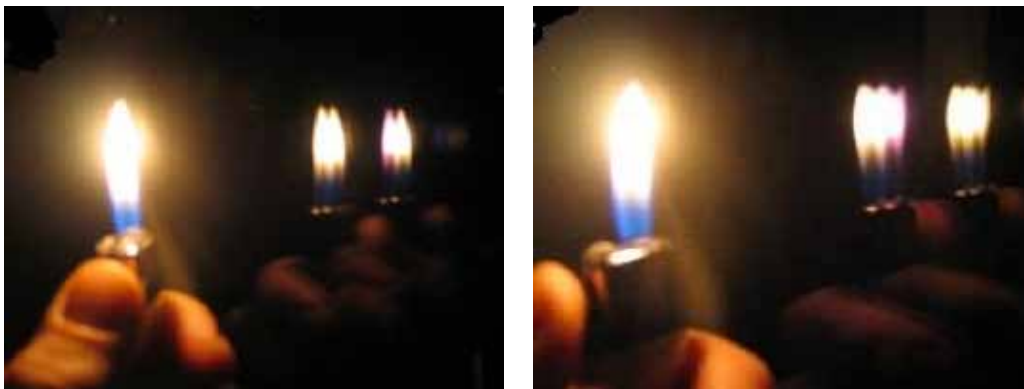
Afb. 4.2 Aantonen HR-coating door verkleuring van de reflectie (links de derde reflectie, rechts de tweede). De eerste vlam op de foto is de vlam van de aansteker. De andere vlammen zijn de reflecties van deze vlam.
